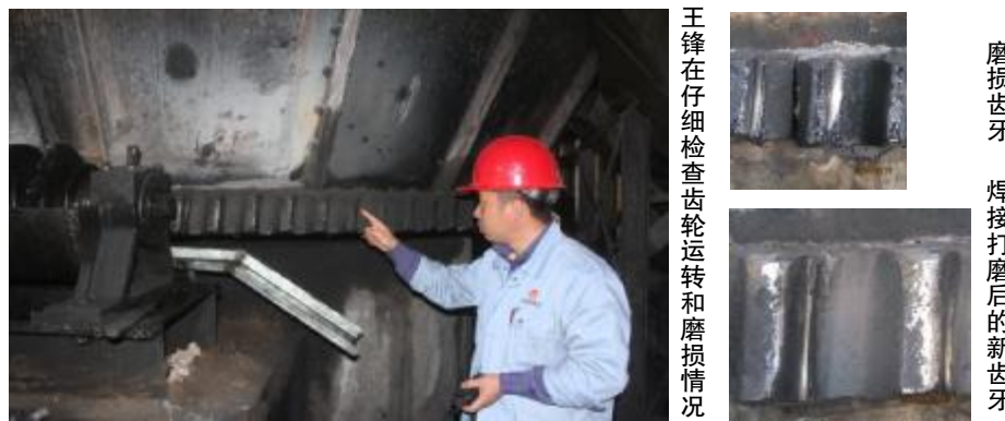
王峰在仔细检查齿轮运转和磨擦齿情况
